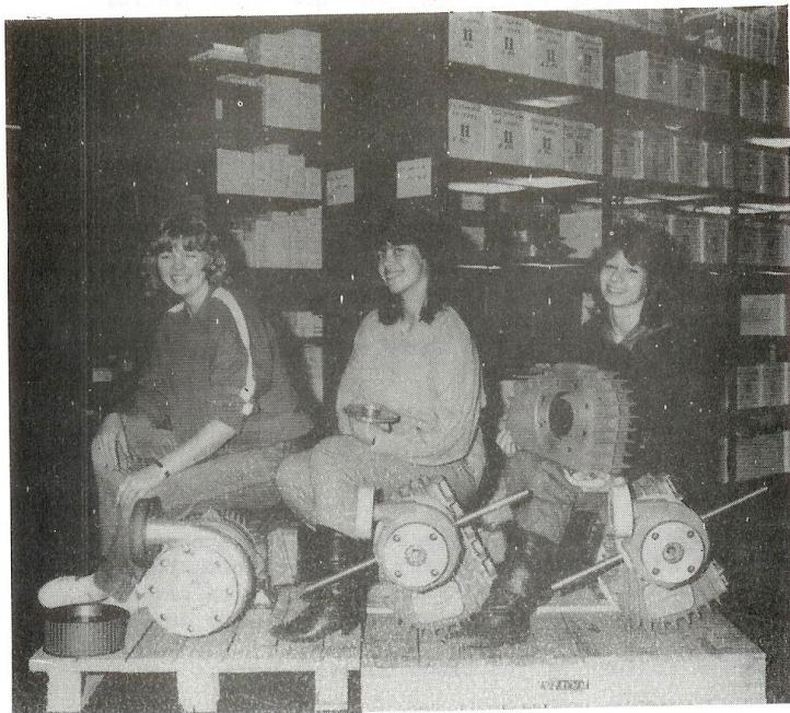
Direct en indirect gedreven pompen. Voor het verplaatsen van vloeistoffen van minus - 172° Celcius zijn deze speciale pompen ontworpen, en in aluminium en brons uitgevoerd. De assemblage en het groot onderhoud van deze precaire accessoires vindt plaats in eigen beheer, terwijl een ruime voorraad reservedelen door de liefelijke dames wordt beheerd. "Wendt u tot ons in tijden van crises": zeggen Peggy, Corinne en Patty.
